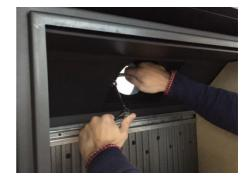
• Lorsque la chambre de combustion est désolidarisée, elle peut être glissée hors du manteau par l'avant du poêle.
