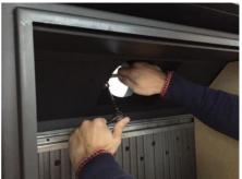
• Lorsque la chambre de combustion est désolidarisée, elle peut être glissée hors du manteau par l'avant du poêle.
